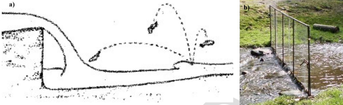
Fig. 3. Barreras excluyentes para salmónidos en ríos. a) Diseño ideal; la barrera se instala en la zona de caída de la corriente, por lo que la corriente ascendente se forma muy lejos, dificultando el salto de los peces (Modificado de Diavanera s/f). b) Barrera simple para aislar el nado corriente arriba de los peces (Modificado de Nebot & Rubio 2012).
